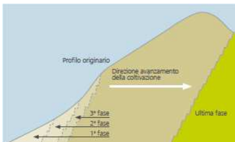
Figura 4.1 Coltivazione a gradoni per fette verticali montanti
